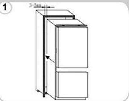
Depois de garantir a correspondência entre a porta do aparelho e a porta da coluna, fixe as tampas de plástico da bolsa de acessórios
