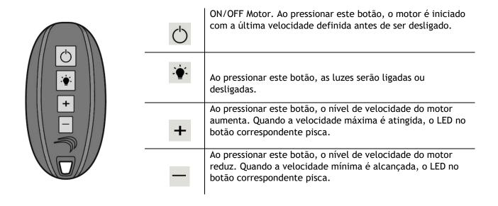
**Nota:** 1. O nível de velocidade é exibido em um visor na tampa perimetral inferior do produto. 2. O controle remoto é fornecido já ajustado e pronto para uso.
